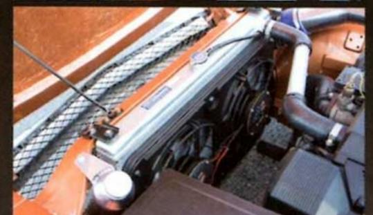
↑熱量の多い V8 4 リッターだけだと大きめのアルミラジエターと電動ファンで対処。マスターシリンダー & マスターバックは日産の大型をチョイス
