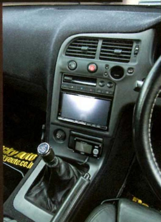
↑センター集中スイッチ類を見ると現代のクルマだけど、これは紛れもなくケンメリ。エアコン付き空調コントロールスイッチに埋め込み式のナビを装着。ワイパー系もライトスイッチもR33を使用しているのでオート機構満載。ちなみにミッションは71C
